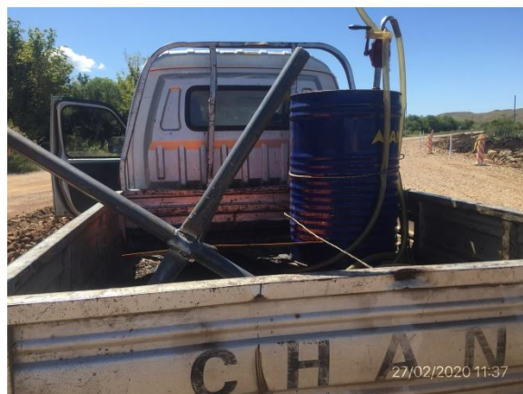
Ilustración 15 – Obrador, P01. Camioneta de servicio para maquinaria vial, carente de bandejas para contención de derrames.
