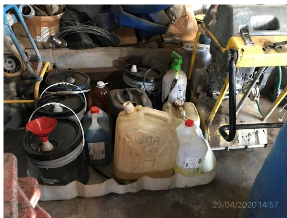
Ilustración 15 – P03, obrador. Depósito de lubricantes en bandejas metálicas dentro de pañol techado
