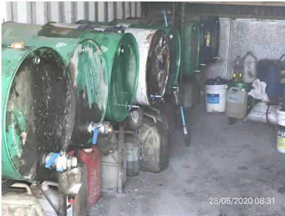
Ilustración 10 – P03. Obrador, sector techado y evallado para trasiego de lubricantes
