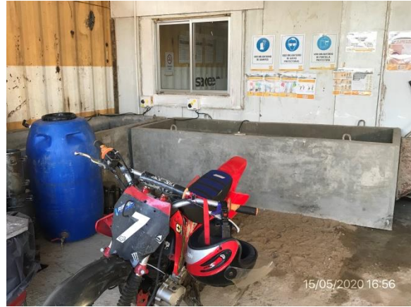
Ilustración 11 – P02. Obrador. Pileta de curado de probetas de hormigón.
