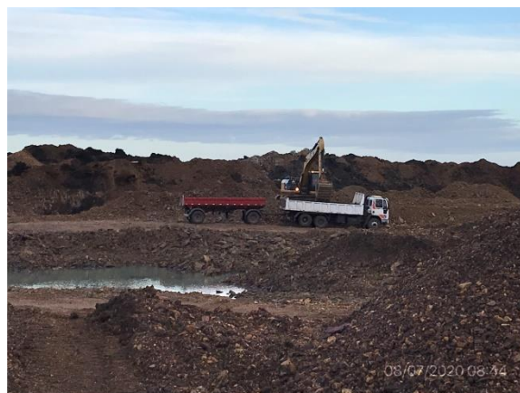
Ilustración 7 – P04, Cantera de tosca y basalto, padrón rural N°1.888, 5ª SC de Paysandú, frente de ataque en yacimiento de basalto.
