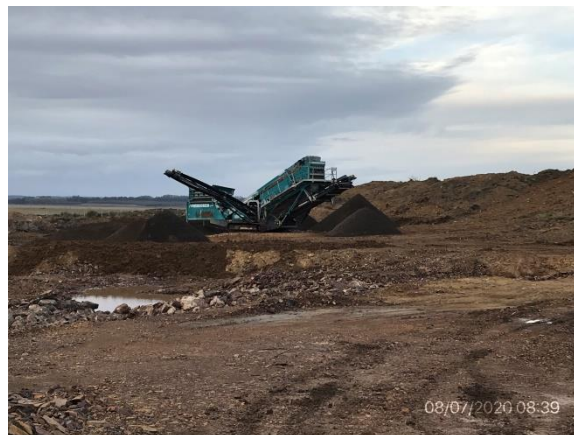
Ilustración 5 – P04 , Cantera de tosca y basalto, padrón rural N°1.888, 5ª SC de Paysandú, planta de trituración
