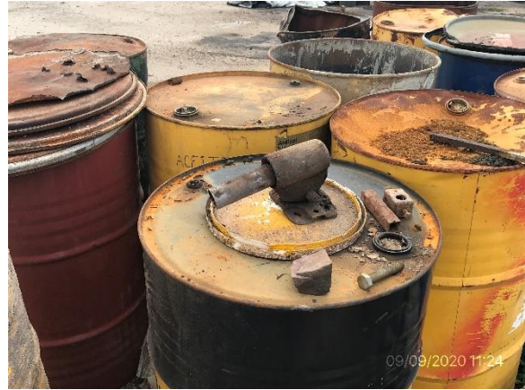
Ilustración 11 – P03, tanques de lubricantes usados a ser retirados, sin contenciones adecuadas ni señalización
