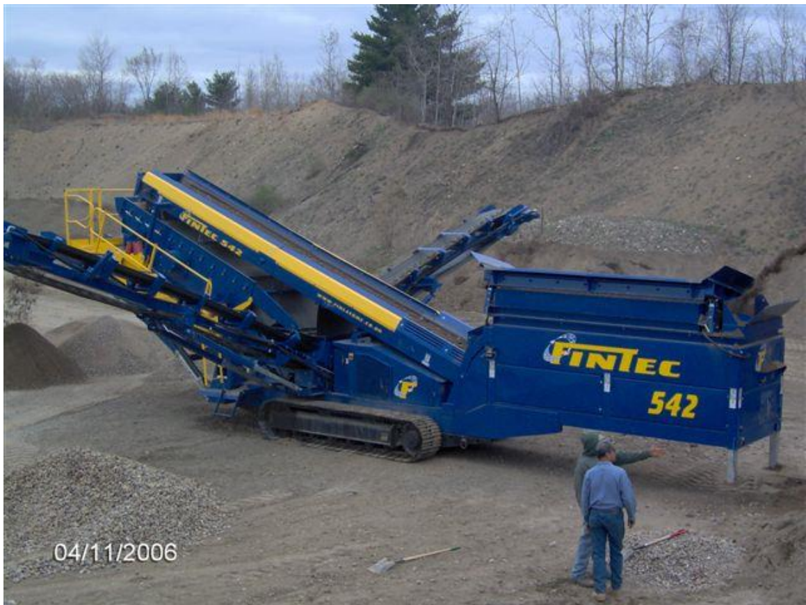
Figura 3: Vista de clasificación por zarandeo con FINTEC 542
