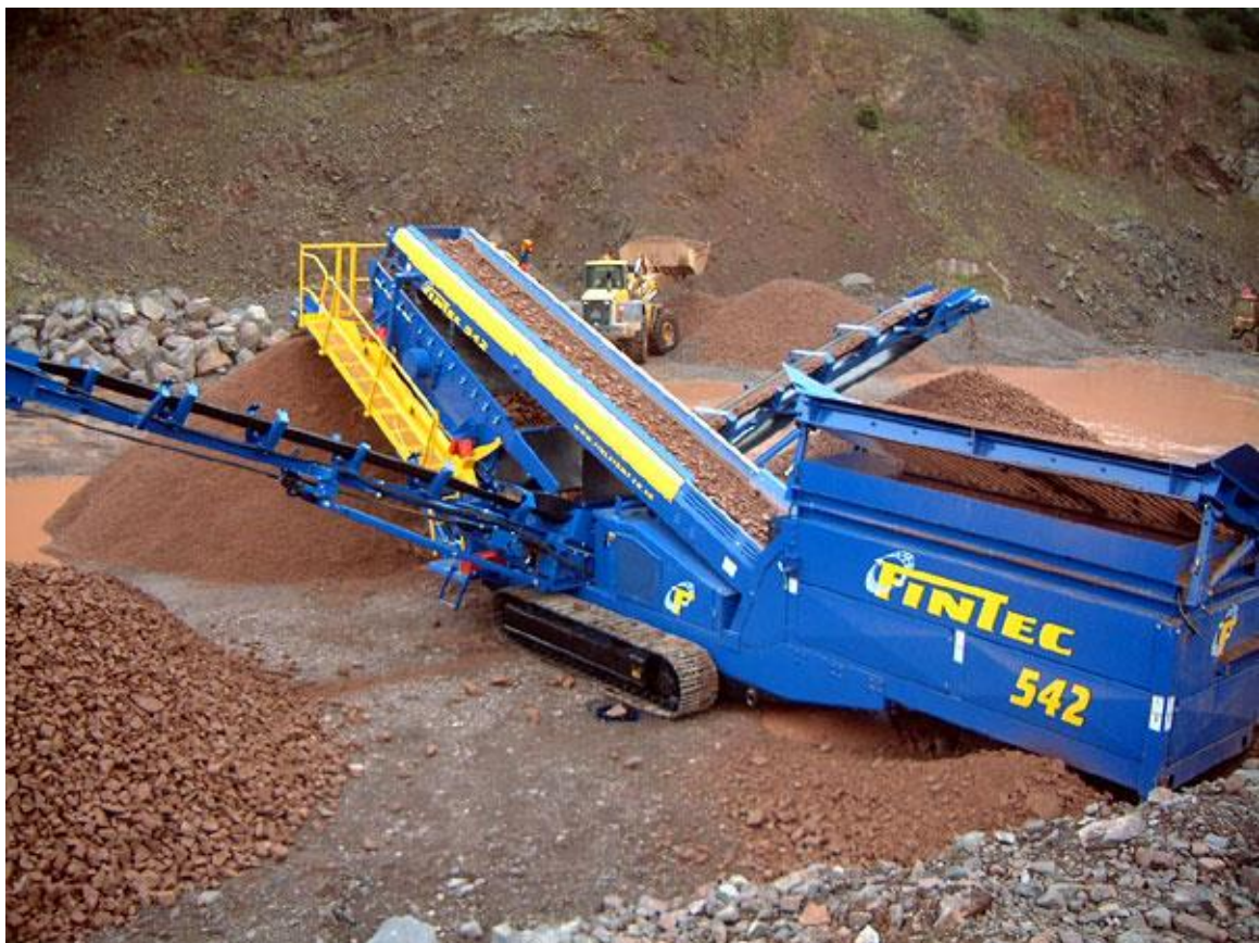
Figura 3: Vista de clasificación por zarandeo con FINTEC 542
