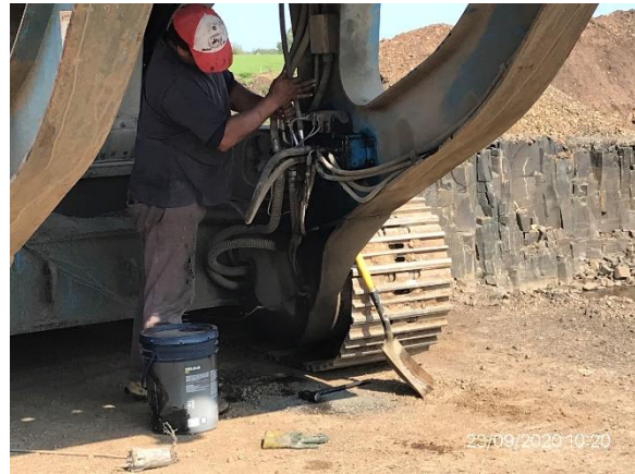
Ilustración 23 – P03, Cantera. Tareas de mantenimiento mecánico sin infraestructura para contención de derrames.
