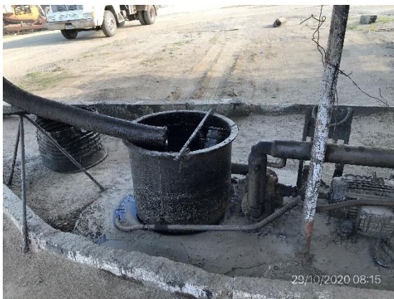
Ilustración 12 – P03, Obrador. Zona de trasiego de emulsiones asfálticas envallada
