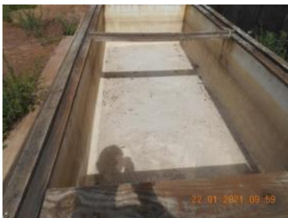
Ilustración 8 – P03, pileta de curado de probetas.
