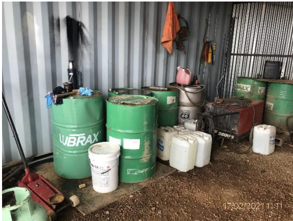
Ilustración 12 – P03, Obrador. Sector de acopio de lubricantes bajo techo, sin envallar y con pavimento granular.
