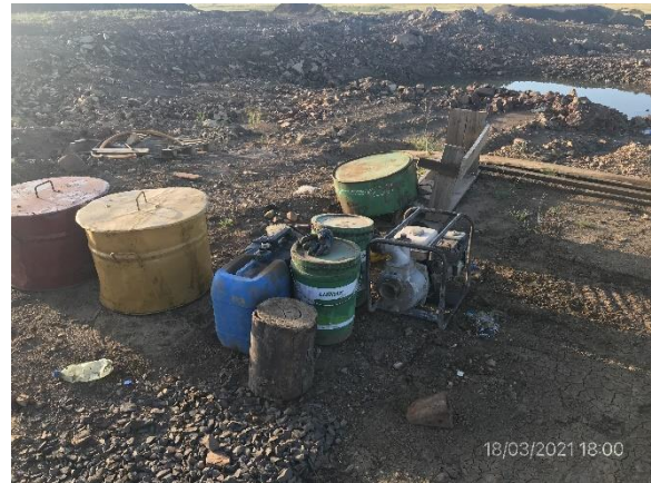
Ilustración 25 – P07, Cantera de basalto. Acopio de lubricantes usados sin contenciones impermeables.
