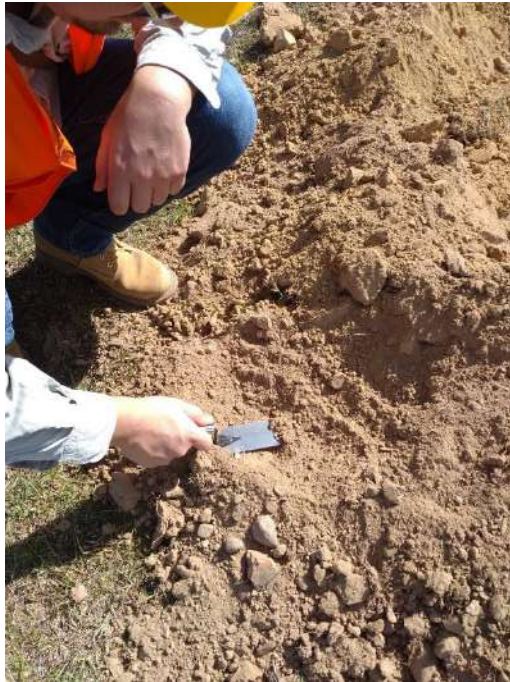
Ilustración 12 Inspección a cucharin de sedimentos removidos del Sondeo 1.
