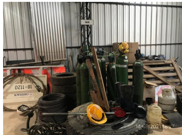
Ilustración 19 – P04, Obrador principal. Depósito, taller mecánico y pañol techados y con piso impermeable.
