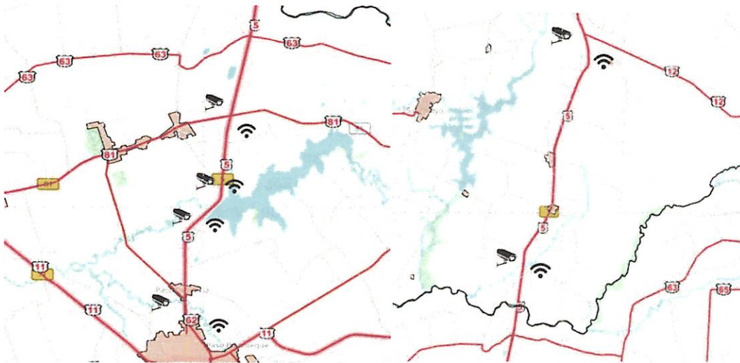
Ilustración 4-2 Ubicación de cámaras CCTV y sensores WIFI en Ruta Nro.5 (zonas 1 y 2)
