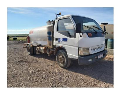
Esta se alimenta desde un tanque de almacenamiento dispuesto en el obrador central y recorre los diferentes frentes de obra llevando el combustible y lubricante necesario para su funcionamiento. Esta unidad está dotada de bandejas y elementos de contención para evitar posibles derrames en su tarea de reparto.
