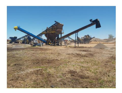
Para el lavado de la piedra triturada para el tratamiento bituminoso, se implementó en el obrador un equipo de lavado, que por medio de una bomba a combustión utiliza el agua acumulada de lluvia para el lavado de piedra, ubicándose en la zona más baja de la cantera, y que reutiliza indefinidamente el agua de cada lavado, para así no contaminar ningún cauce a lo largo de la traza de la obra.
