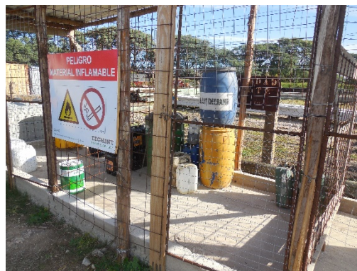
Figura 6-1 Recinto de Acopios de residuos peligrosos.
