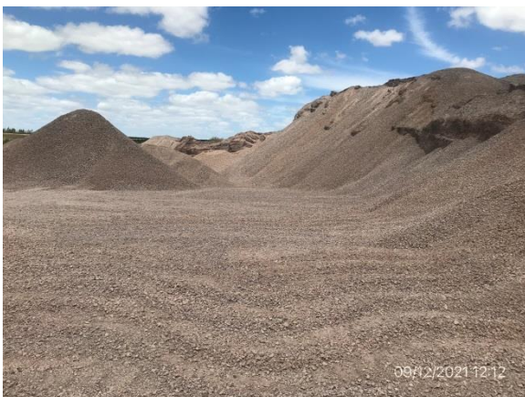
Ilustración 14 – P03, Cantera. Acopios de material triturado.
