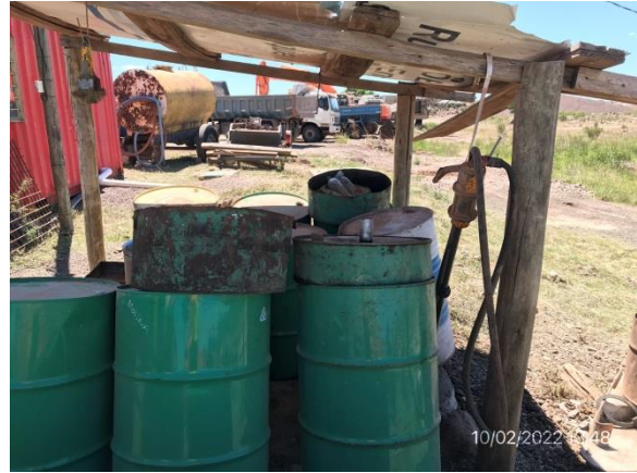
Ilustración 23 – P03. Planta asfáltica. Sector techado y envallado para acopio de lubricantes usados.
