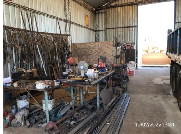
Ilustración 17 – P03. Obrador. Taller de maquinaria cerrado con pavimento impermeable.
