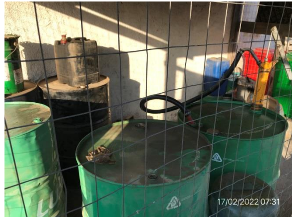
Ilustración 11 – P03, Obrador principal, Sarandí del Yí. Depósito de lubricantes techado y con pavimento impermeable y envallado.
