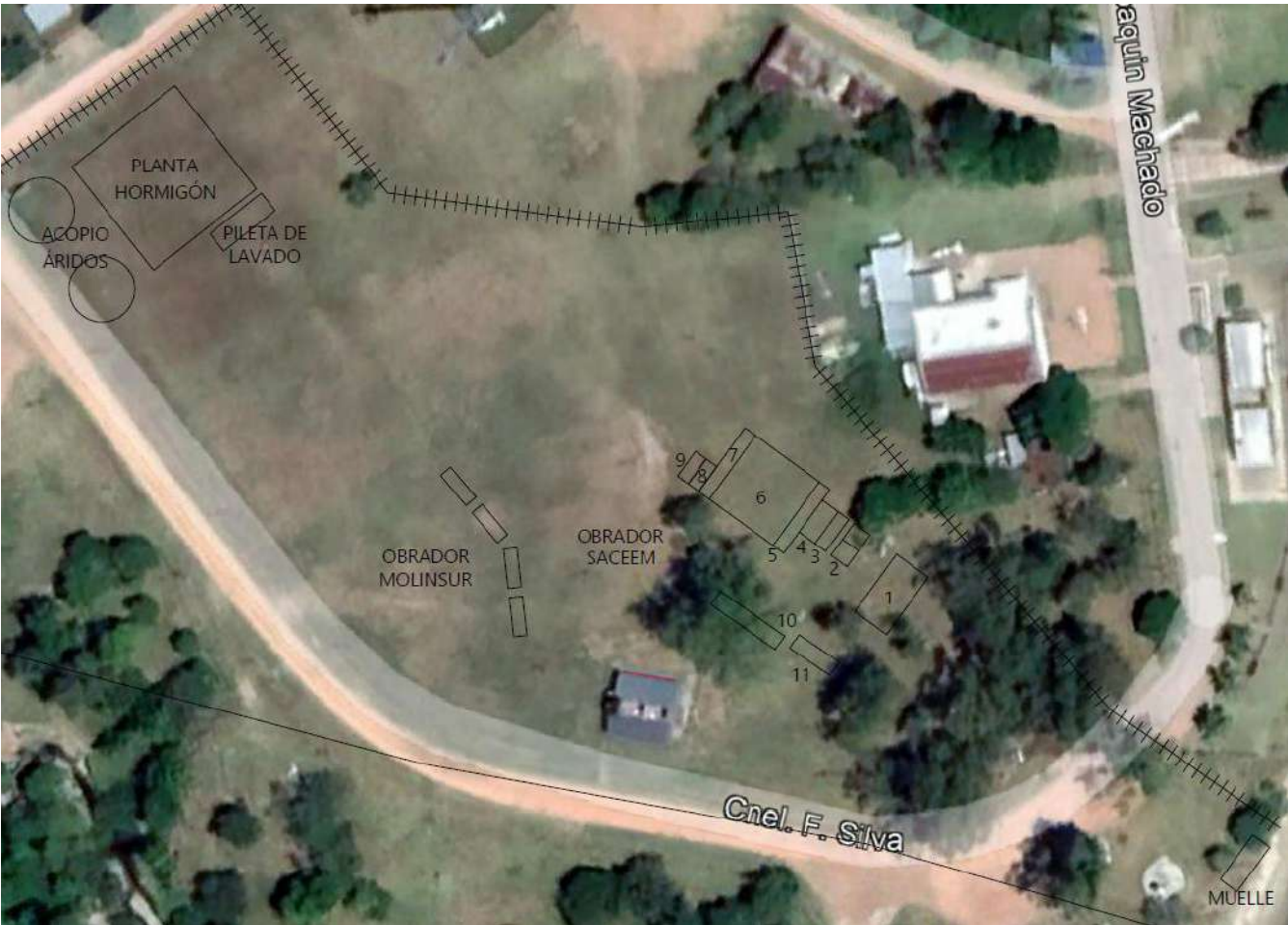
Figura 2: Distribución de instalaciones en obrador
