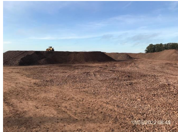
Ilustración 17 – P06, cantera de balasto. Sector de acopio de áridos. No hay infraestructura para mantenimiento mínimo de maquinaria
