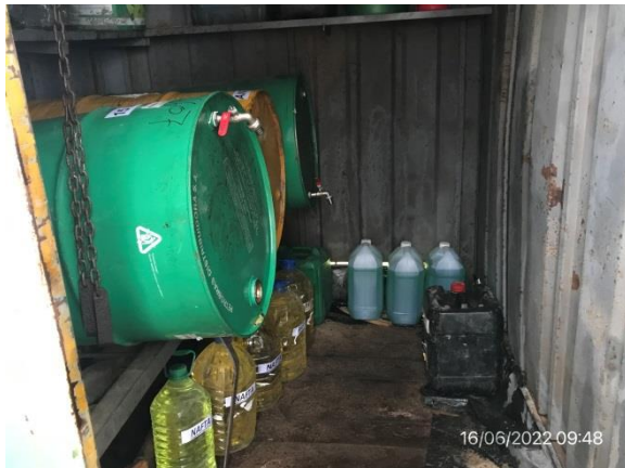
Ilustración 6 – P04, Obrador principal de Incoci SA. Depósito cerrado de hidrocarburos y productos químicos correctamente identificados.
