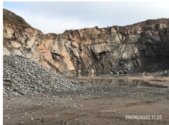
Ilustración 13 – P04. Cantera de piedra explotada por Meliter SA. Material de voladura listo para ser triturado.
