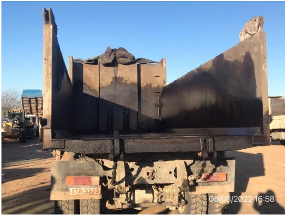
Ilustración 10 – P03, Obrador. Camión para transporte de asfalto. No hay evidencia del procedimiento utilizado para realizar el alije de restos de mezcla asfáltica.
