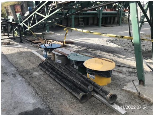
Ilustración 12 – P04, Obrador. Planta asfáltica. Estación de acopio de residuos de forma segregada por corriente de generación.
