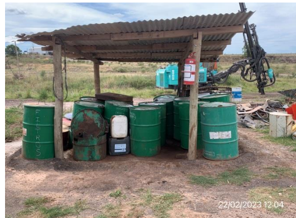
Ilustración 19 – P03, Cantera. Depósito de combustibles con envallado perimetral impermeable.
