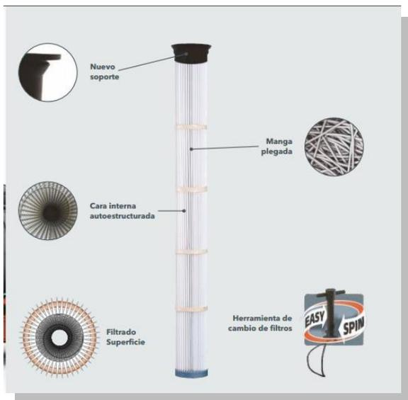
El filtro de mangas está compuesto por 144 PulsePleat de 5 m<sup>2</sup> cada una, resultando en 720 m<sup>2</sup> de área total. Según el manual del fabricante la emisión de material particulado teórica es  $\leq 50$  mg/Nm<sup>3</sup> y las mediciones de campo arrojan resultados  $\leq 10$  mg/Nm<sup>3</sup>. Una vez instalada y en funcionamiento se realizarán mediciones para corroborar las indicaciones del fabricante para estar dentro de los parámetros permitidos de emisiones al aire.
