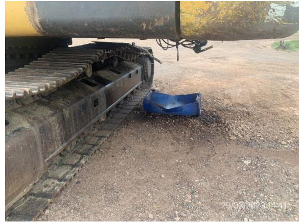
Ilustración 17 – P04, Cantera. Máquina retroexcavadora en reparación sin infraestructura apropiada de taller mecánico. Suelo desnudo con evidencia de derrames de aceite.
