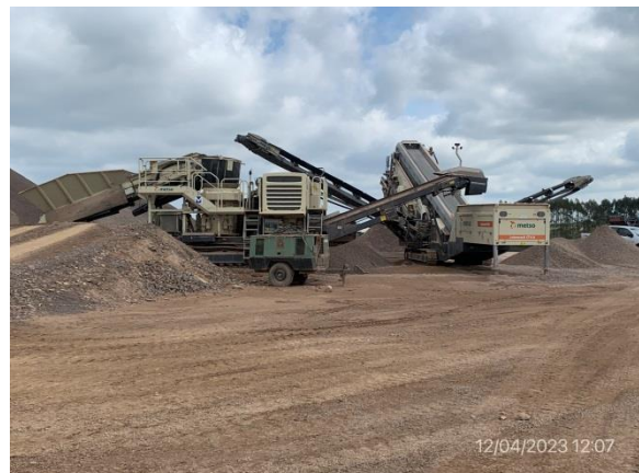
Ilustración 7 – P04, cantera de basalto. Trenes de trituración primaria y secundaria sin actividad.
