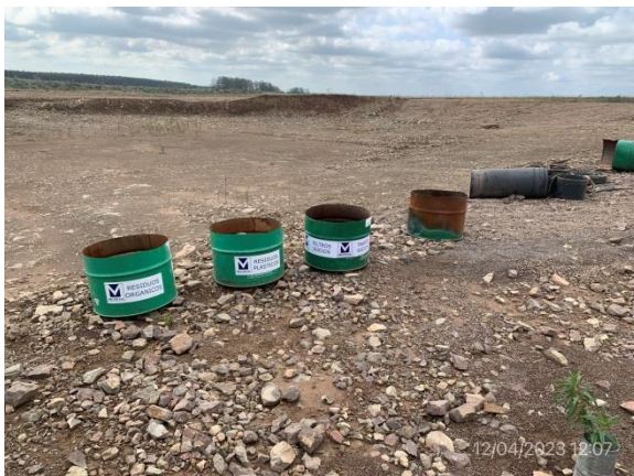
Ilustración 6 – P04, cantera de basalto. Estación para segregación de residuos por corriente de generación.
