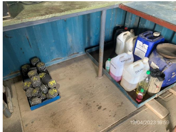
Ilustración 17 – P05. Obrador. Residuos peligrosos del Laboratorio de asfalto con envallados correctos.
