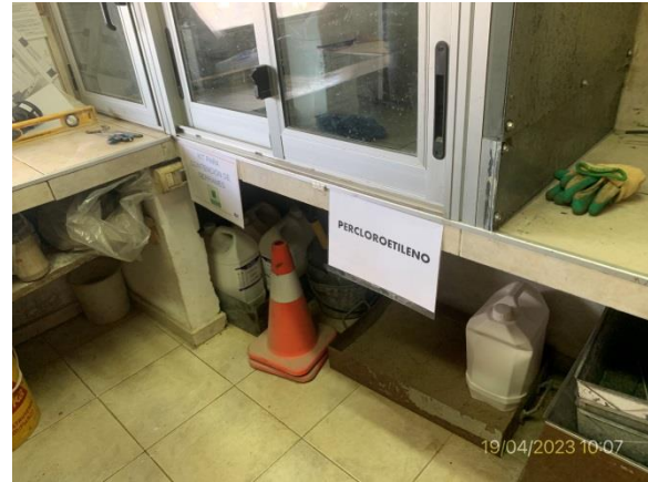
Ilustración 11 – P03, Obrador. Laboratorio de suelos y asfaltos, acopio de percloroetileno usado, correctamente contenido.
