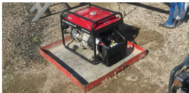
Foto 13.1-2 Corrección luego de la auditoría - bandeja de contención.
