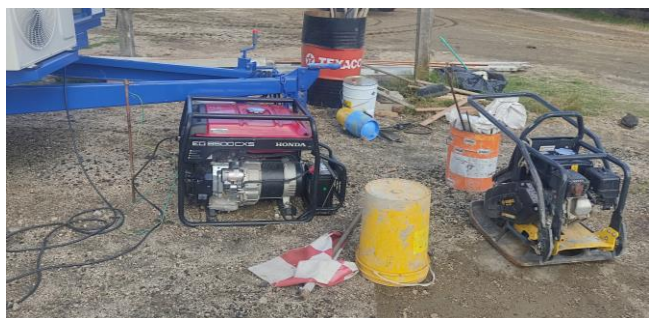
Foto 13.1-1 Generador sin dique de contención.
