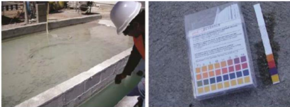
Figura 6-5 Medición de pH
