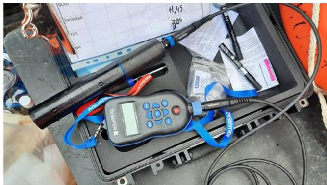
Figura 11-1 Equipo multiparámetro utilizado
