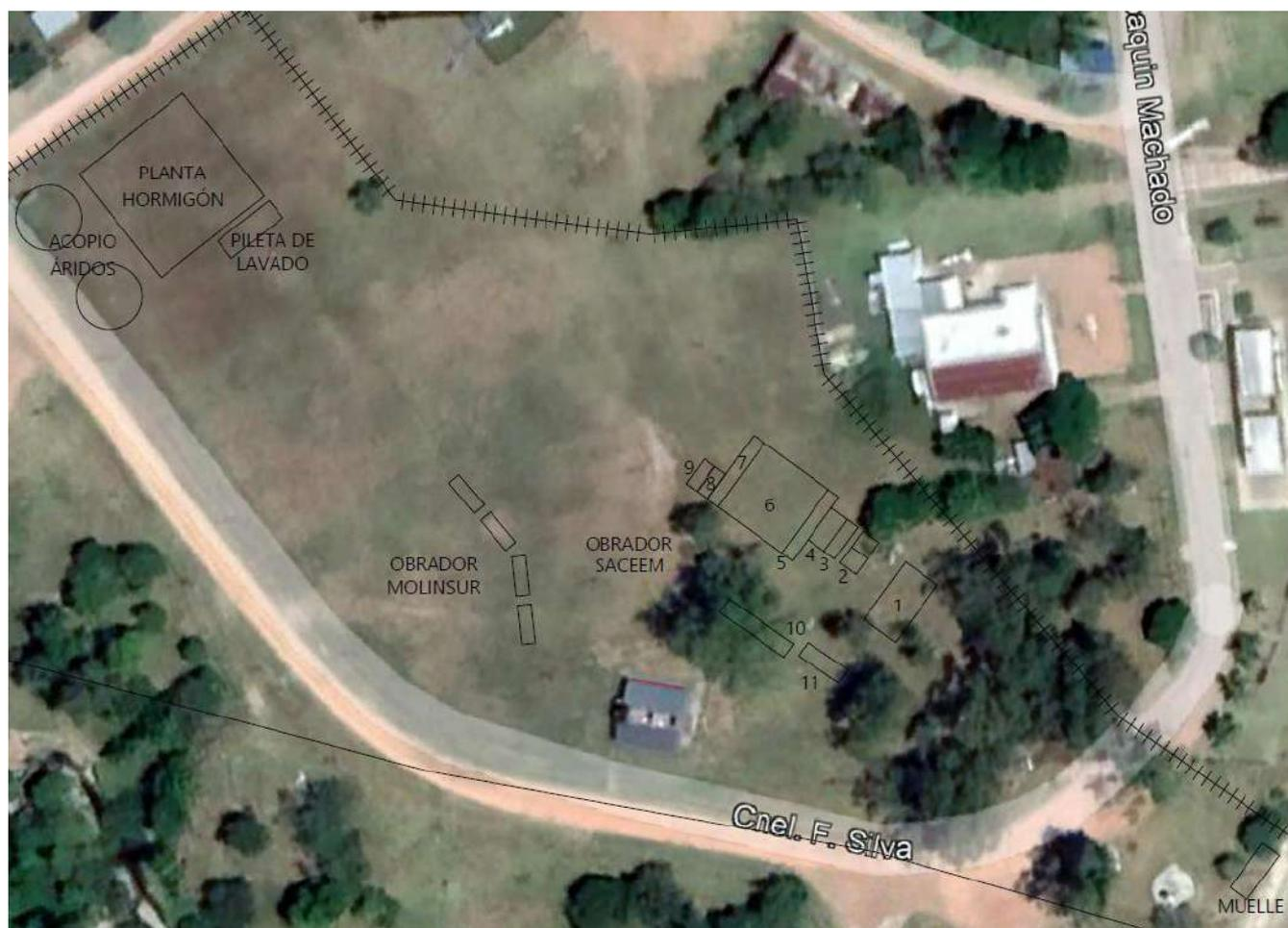
**Figura 2:** Distribución de instalaciones en obrador
