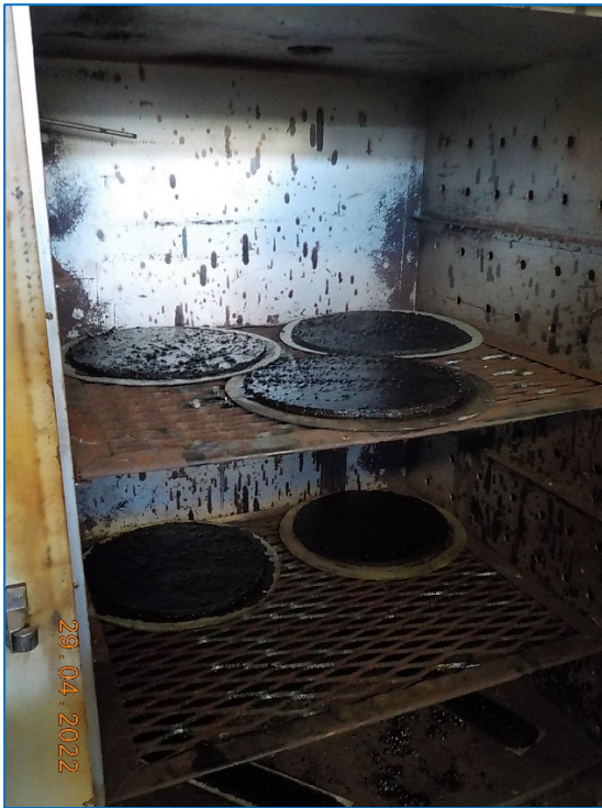
Muestras elaboradas para ensayos de desgaste y de exudación en la dosificación del mortero asfáltico..
