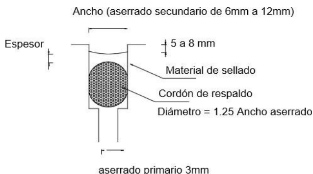
Ilustración 3. Croquis sellado de juntas
