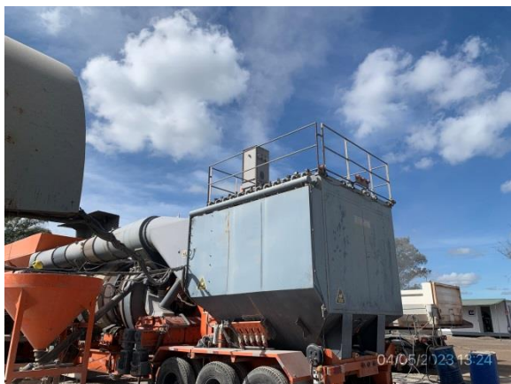
Ilustración 6 – P05, Planta asfáltica. Emisiones gaseosas y de material particulado a la atmósfera fuera de rangos admisibles.
