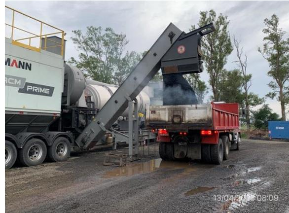
Ilustración 11 – P03, Planta Asfáltica. Descarga de mezcla asfáltica en camiones.
