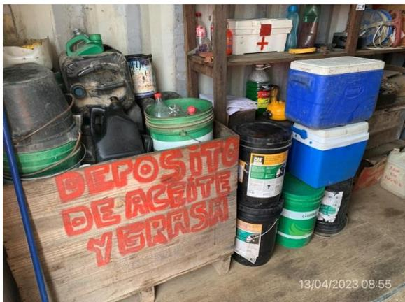
Ilustración 20 – P04, Cantera. Sector de acopio de lubricantes usados sin contención estanca para prevenir derrames.
