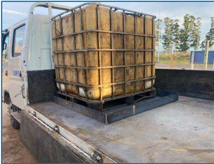
A comienzos del trimestre se implementó bandeja estanca para eventual contención de hidrocarburos.
