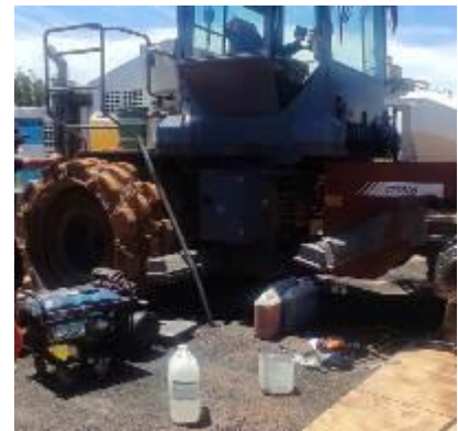
Foto 12.1-1 Tanques con hidrocarburo sin bandeja durante tarea de mantenimiento.
