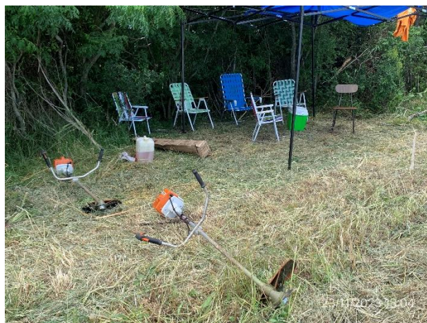
Foto 12.1-6, P03. Bidón de combustible apoyado sobre suelo desnudo, sin elementos de contención de derrames.
