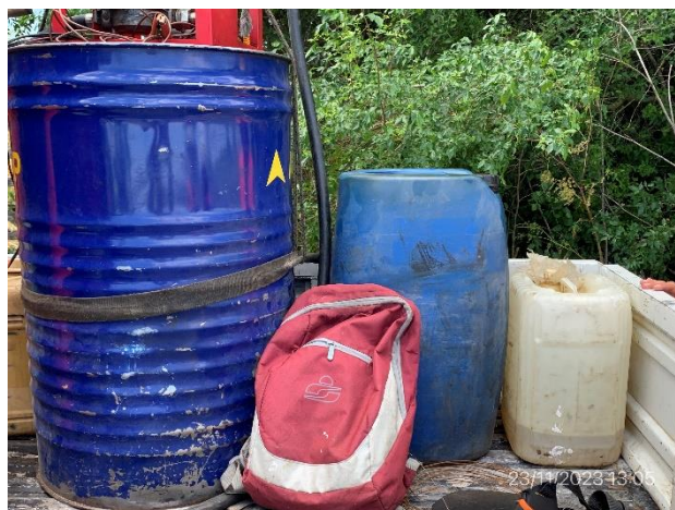
Foto 12.1-4, P03. Camión surtidor de combustible y lubricantes sin elementos de contención de derrames.
