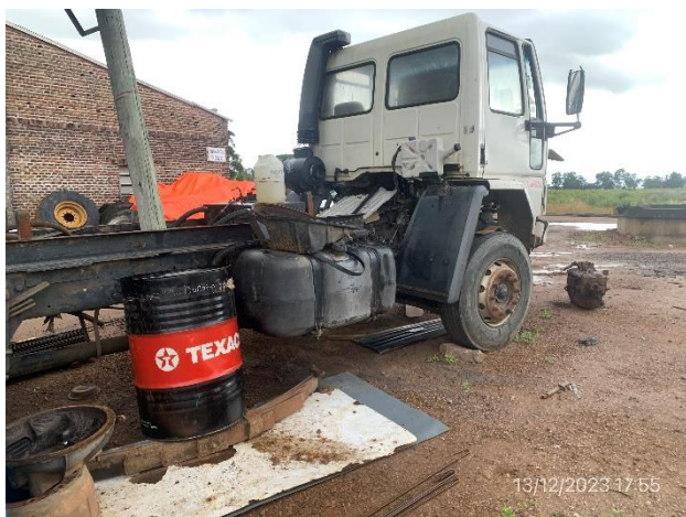
Foto 12.1-23, P03. Obrador, se realizan tareas de mantenimiento mecánico en un sector inapropiado, sin posibilidades de contención de aguas oleosas.
