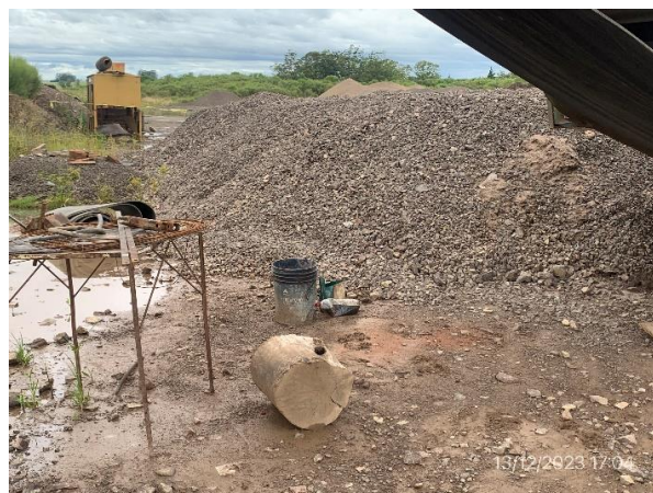
Foto 12.1-18, P04. Trituradora secundaria en mantenimiento. Contenedores plásticos con lubricantes sin bandejas de contención, apoyados sobre suelo desnudo.
