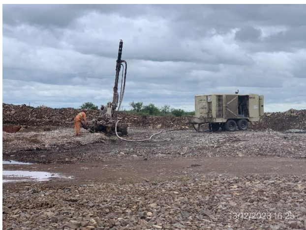
Foto 12.1-5, P05. Cantera, barrenado de yacimiento en proceso
