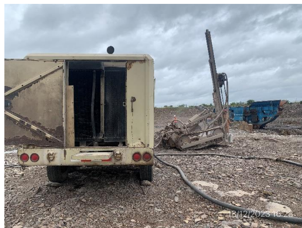
Foto 12.1-6, P05. Cantera, motocompresor alojado en camión con sector estanco para prevención de derrames.
