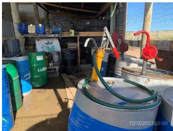
Foto 12.1-6, P03. Obrador, sector envallado para acopio de lubricantes en uso.
