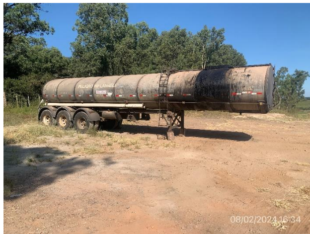
Foto 12.3-6, P07. Estacionamiento de cisterna de emulsión en faja pública, Ruta 30 progresiva 240K400 a (-). No hay impermeabilización de suelo ni envallado perimetral.
