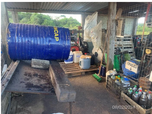
Foto 12.1-11, P05. Depósito de lubricantes en local con techo y envallado correctos. Sin embargo, hay bidones en bandejas no aptas para transporte de lubricantes.
