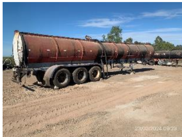
Foto 12.1-8, P05. Obrador, segunda cisterna estacionada en zona inapropiada por no contar con elementos previstos en el PGA para la prevención de derrames.
