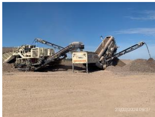
Foto 12.1-12, P06. Cantera de basalto, tirturación de áridos en proceso.
