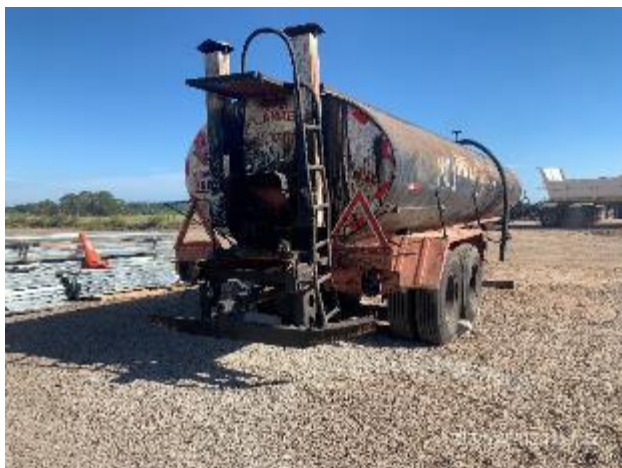
Foto 12.1-7, P05. Obrador, cisterna estacionada en zona inapropiada por no contar con elementos previstos en el PGA para la prevención de derrames.
