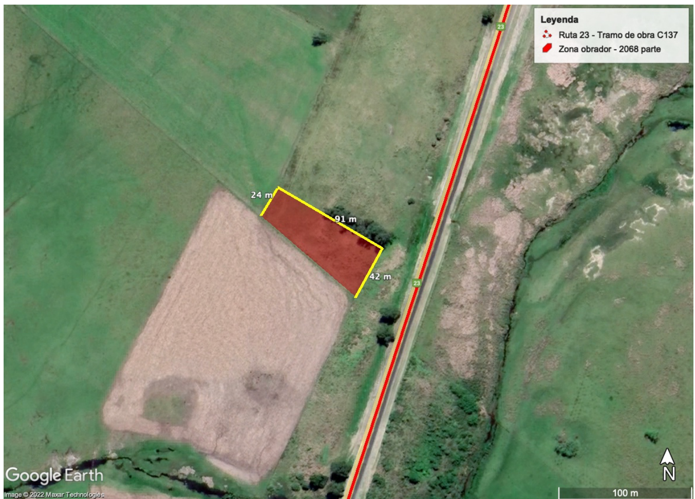
Imágen 4 - Ubicación y dimensiones del obrador
