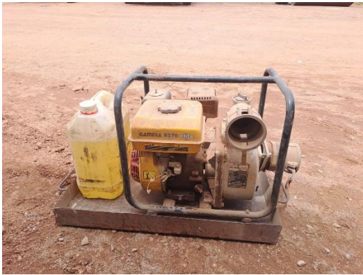
Imagen 1 – Bomba y tanque de combustible en bandeja de contención
